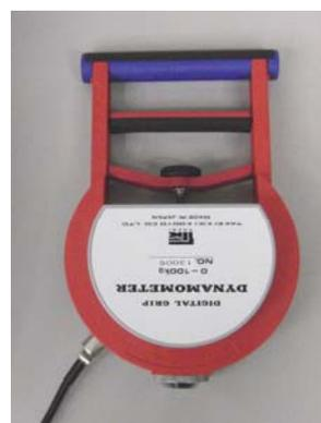
上記の握力計は、歪みゲージ(ストレインゲージ)を使い、歪みを電気信号に変換し測定値を表示しています。(写真左①：測定風景、写真右②：表示板、写真右③：測定アタッチメント)
